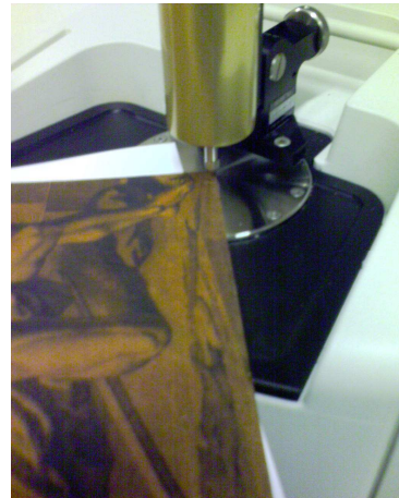
Analyse in situ par ATR de la gravure "L'esclave"
